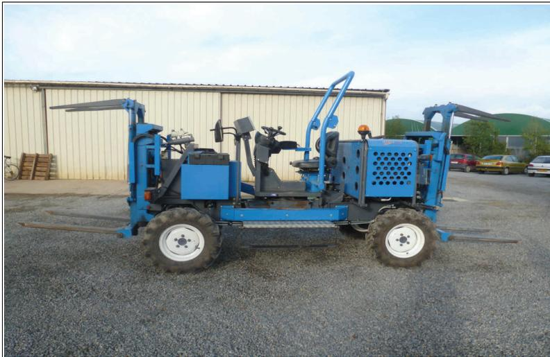
Ce chariot a un poste de conduite réversible, réglable en hauteur. Il est équipé d'un matériel élévateur avec presse palette avant et arrière.
